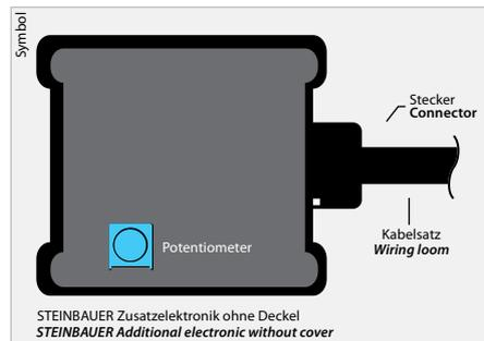
Mit passendem Werkzeug den Deckel der STEINBAUER Zusatzelektronik öffnen.
